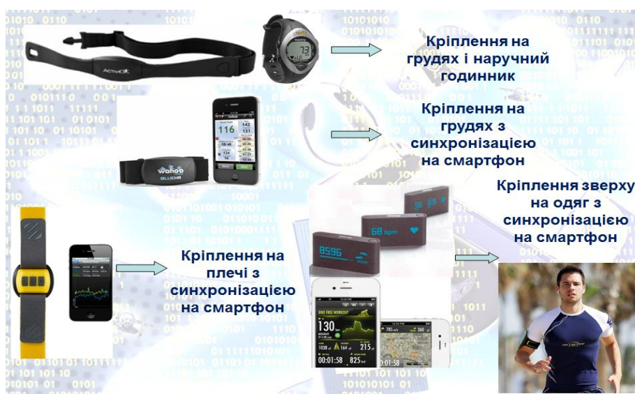
Рисунок 2.7. Використання сенсора для визначення часу, пройдені дистанції, швидкості й кількості витрачених калорій.
